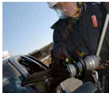
Разжиматель с ручным приводом с усилием 4.5 т.
