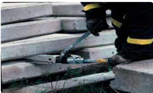
Разжиматель с ручным приводом с усилием 4.5 т.
